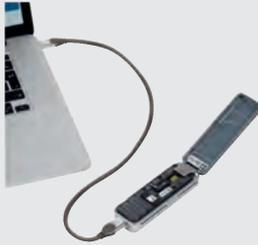
MinION es el único dispositivo portátil para la secuenciación de ADN y ARN en tiempo real. Imagen cortesía de Oxford Nanopore Technologies.
